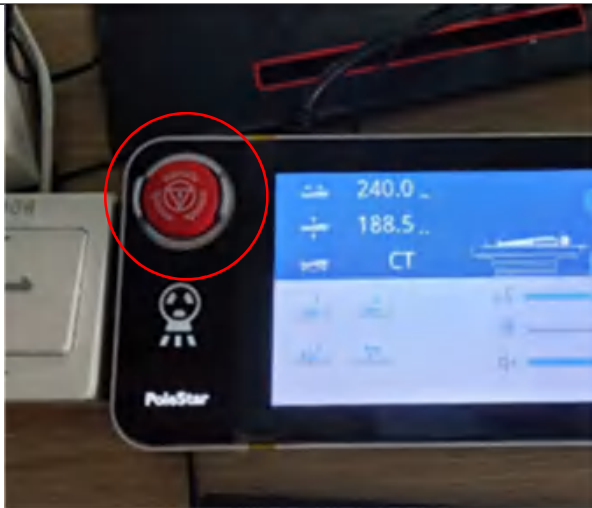
图 3-5 本项目急停按钮现场照片
